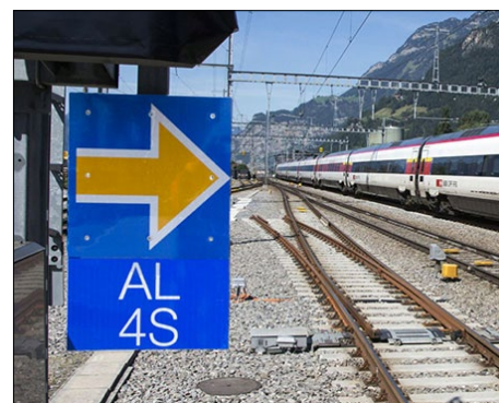
ETCS ist in einigen Nachbarländern schon sehr viel weiter entwickelt. Hier eine Halt-Tafel – das eigentliche Signal wird dann nicht mehr benötigt – in der Schweiz.
