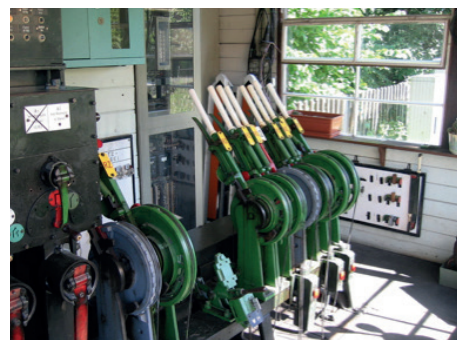
Kein Witz: Stellwerke wie dieses mit Seilzugtechnik (ca. 100 Jahre alt) gibt es noch immer im deutschen Gleisnetz.
